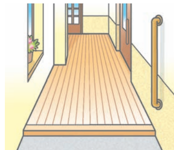
廊下幅の確保
