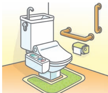
手すりの設置
